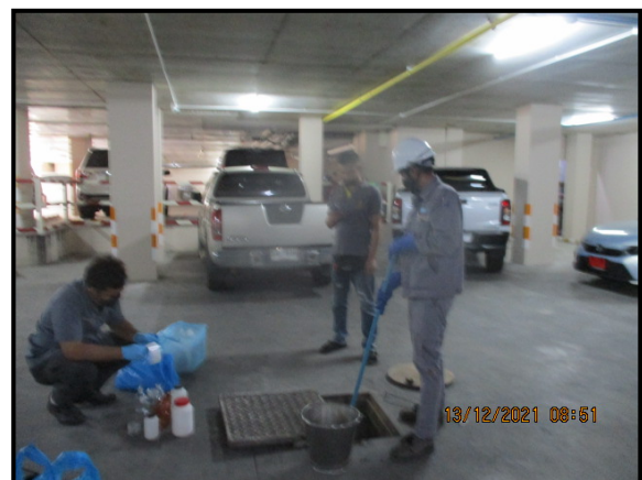
รูปที่ 3-1 แสดงการเก็บตัวอย่างน้ำเสียจุดที่ 1 บริเวณจุดรวบรวมน้ำเสียเข้าระบบบำบัดน้ำเสีย
