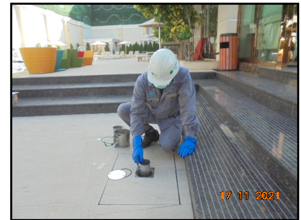
รูปที่ 3-3 แสดงการเก็บตัวอย่างน้ำทิ้งจุดที่ 3 บริเวณบ่อพักน้ำสุดท้ายของระบบระบายน้ำโครงการก่อนระบายออกจากโครงการ
