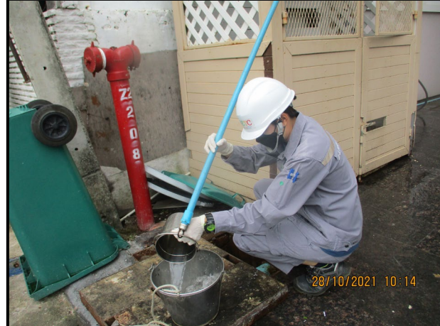
รูปที่ 3-2 แสดงการเก็บตัวอย่างน้ำทั้งจุดที่ 2 บริเวณบ่อกักน้ำสุดท้ายของระบบระบายน้ำโครงการก่อนระบายออกจากโครงการ
