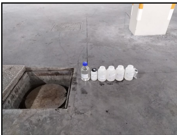
รูปที่ 3-1 แสดงการเก็บตัวอย่างน้ำเสียจุดที่ 1 บริเวณจุดรวบรวมน้ำเสียเข้าระบบบำบัดน้ำเสีย
