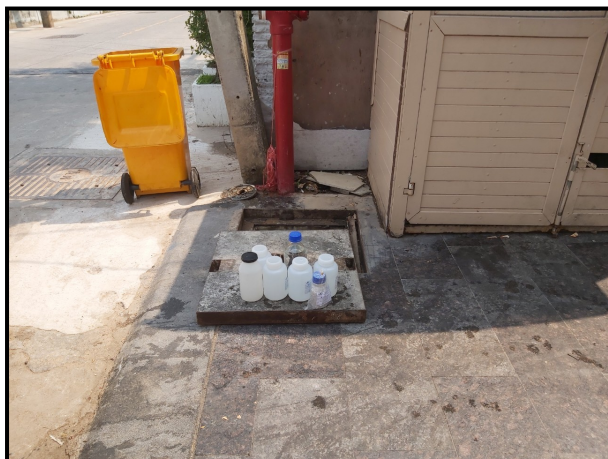
รูปที่ 3-2 แสดงการเก็บตัวอย่างน้ำทั้งจุดที่ 2 บริเวณบ่อกักน้ำสุดท้ายของระบบระบายน้ำโครงการก่อนระบายออกจากโครงการ
