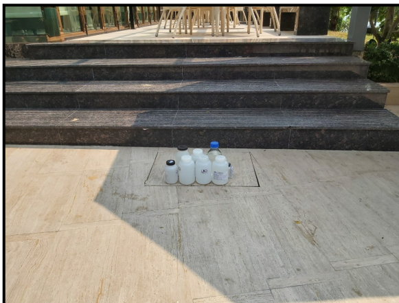
รูปที่ 3-3 แสดงการเก็บตัวอย่างน้ำทิ้งจุดที่ 3 บริเวณบ่อพักน้ำสุดท้ายของระบบระบายน้ำโครงการก่อนระบายออกจากโครงการ
