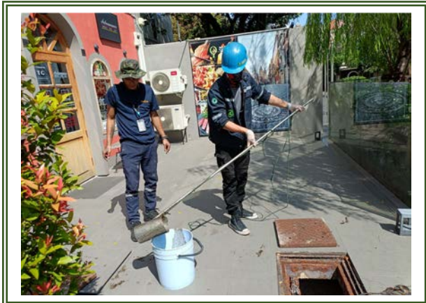
รูปที่ 3-3 การเก็บตัวอย่างคุณภาพน้ำทิ้ง บริเวณจุดรวบรวมน้ำเสียก่อนเข้าสู่ระบบบำบัด
