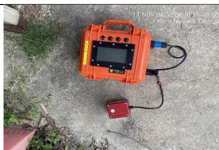
รูป 30 ตรวจวัดแรงสั่นสะเทือน และแรงอัด อากาศจากการใช้วัตถุระเบิดของโครงการจำนวน 2 สถานี
