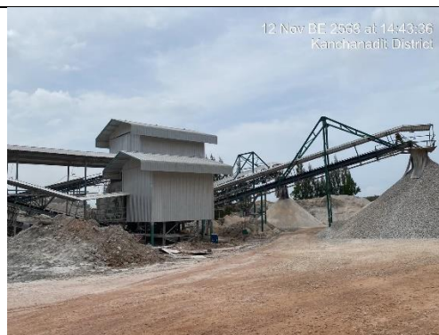
รูป 10 การปิดคลุมตะแกรงคัดขนาด
