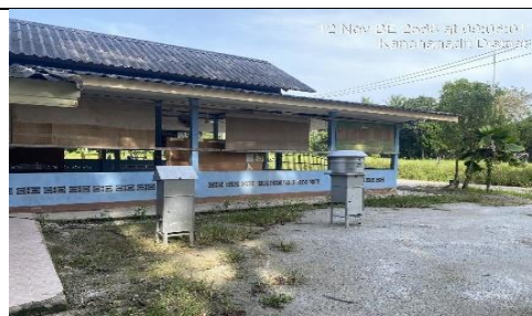
รูป 28 ตรวจวัดปริมาณฝุ่นละอองแขวนลอยในบรรยากาศ TSP และ PM10 เฉลี่ยในรอบ 24 ชั่วโมงเป็นเวลา 3 วัน ต่อเนื่อง โดยใช้เครื่อง High Volume Air Sampler จำนวน 4 สถานี
