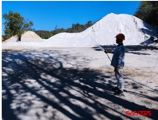
รูปที่ 14 ระบบสเปรย์น้ำบริเวณที่เป็นแหล่งกำเนิดฝุ่นละออง
