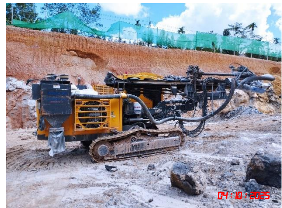
รูปที่ 13 เครื่องเจาะระเบิดที่มีอุปกรณ์ดูดฝุ่นติดตั้งบริเวณหัวเจาะ
