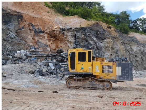
รูปที่ 13 เครื่องเจาะระเบิดที่มีอุปกรณ์ดูดฝุ่นติดตั้งบริเวณหัวเจาะ
