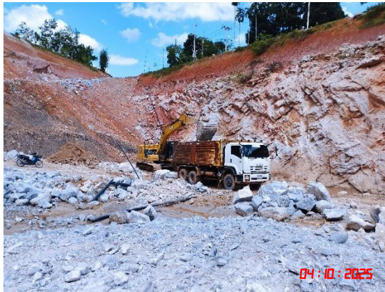
รูปที่ 7 การตักขนแร่ออกจากหน้าเหมืองก่อนการระเบิดในครั้งถัดไป
