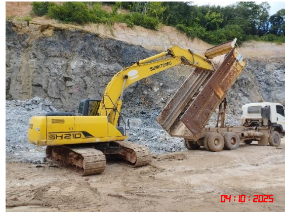
รูปที่ 7 การตักขนแร่ออกจากหน้าเหมืองก่อนการระเบิดในครั้งถัดไป
