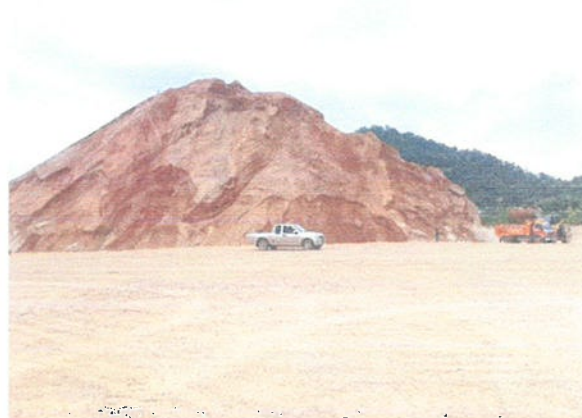
รูปที่ 5 เปลือกดินจากหน้าเหมื่อนนำมาผสม เป็นหินคลุก
