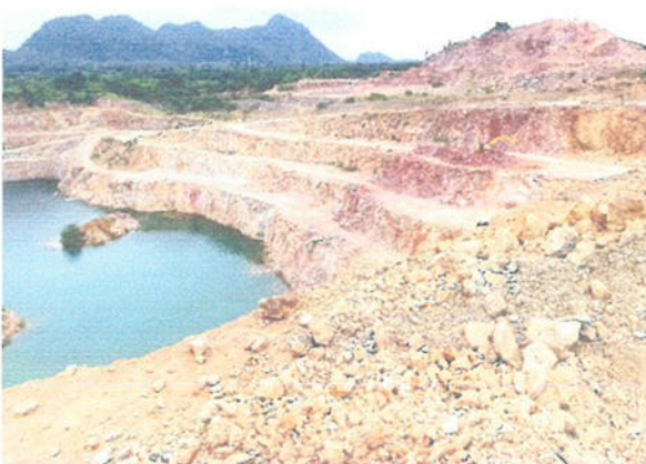
รูปที่ 2 การพัฒนาและเปิดหน้าเหมืองหน้าเหมือง ให้เป็นชั้นบันไดด้านทิศใต้
