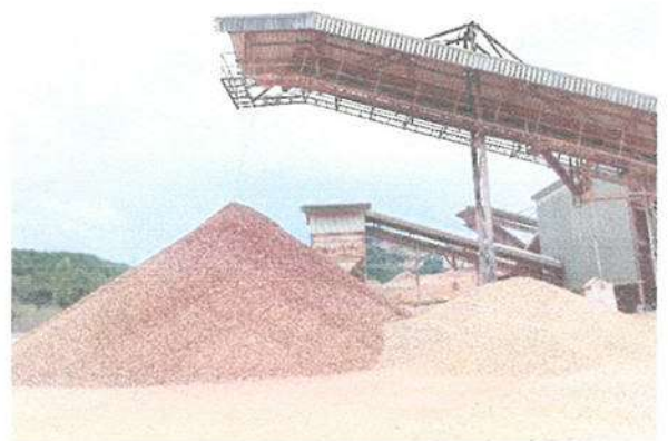
รูปที่ 16 การปิดคลุมสายพานลำเลียง
