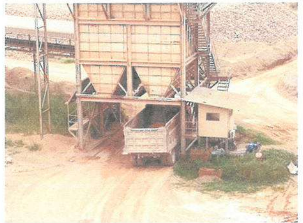
รูปที่ 17 การออกแบบถังเก็บหิน เพื่อลดการฟุ้งกระจายของฝุ่นหินจากปลายสายพาน
