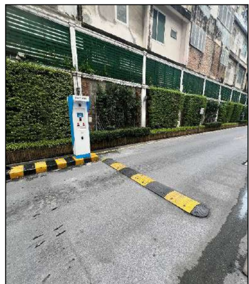
ภาพที่ 2-2 ป้ายจำกัดความเร็วรถที่ 20 กม./ชม. และสัณฐานเพื่อช่วยชะลอความเร็วรถ
