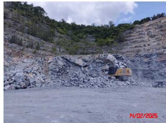
รูปที่ 8 การตักขนำก่อนแร่และเศษหินบริเวณด้านบนของหน้าระเบิด
