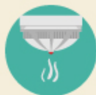
ถอดที่ฝาครอบเครื่องจับควัน เพื่อควันจะได้สัมผัสกับ sensor เมื่อเกิดเหตุ
