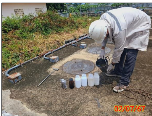
จุดเก็บน้ำก่อนเข้าสู่ระบบบำบัดน้ำเสีย บริเวณบ่อสูบน้ำ
