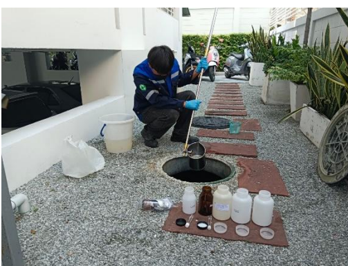
รูปที่ 3.2-2 การตรวจวัดคุณภาพน้ำทิ้ง บริเวณที่ตรวจวัด : บ่อตรวจคุณภาพน้ำเสียก่อนเข้าระบบบำบัดน้ำเสียตึกเก่า
