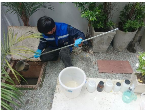
รูปที่ 3.2-3 การตรวจวัดคุณภาพน้ำทิ้ง บริเวณที่ตรวจวัด : บ่อตรวจคุณภาพน้ำเสียออกระบบบำบัดน้ำเสีย
