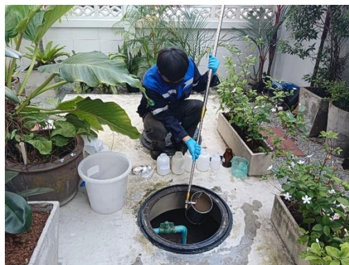
รูปที่ 3.2-1 การตรวจวัดคุณภาพน้ำทิ้ง บริเวณที่ตรวจวัด : บ่อตรวจคุณภาพน้ำเสียก่อนเข้าระบบบำบัดน้ำเสียตึกใหม่
