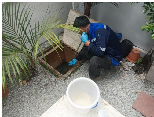
รูปที่ 3.2-3 การตรวจวัดคุณภาพน้ำทิ้ง บริเวณที่ตรวจวัด : บ่อตรวจคุณภาพน้ำเสียออกระบบบำบัดน้ำเสีย
