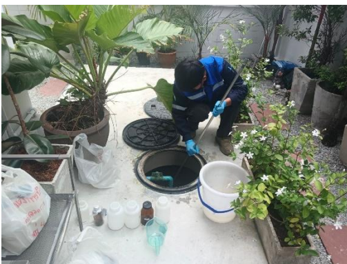
รูปที่ 3.2-1 การตรวจวัดคุณภาพน้ำทิ้ง บริเวณที่ตรวจวัด : บ่อตรวจคุณภาพน้ำเสียก่อนเข้าระบบบำบัดน้ำเสียตึกใหม่
