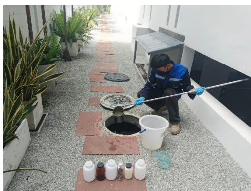
รูปที่ 3.2-2 การตรวจวัดคุณภาพน้ำทิ้ง บริเวณที่ตรวจวัด : บ่อตรวจคุณภาพน้ำเสียก่อนเข้าระบบบำบัดน้ำเสียตึกเก่า
