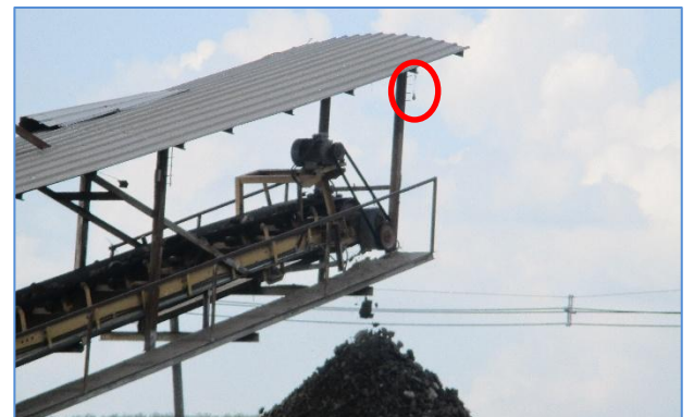
รูปที่ 2.2-5 ระบบสเปรย์น้ำของโรงโม่
