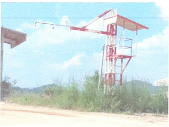
รูปที่ 21 ระบบสเปรย์น้ำบนกระบะรถบรรทุกหิน ก่อนเทหินลงปากม่
