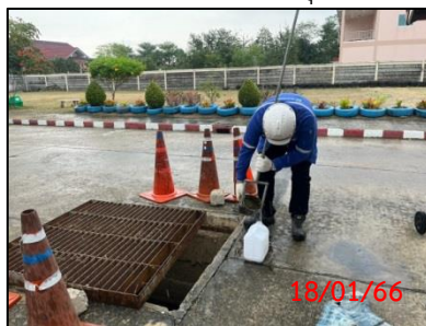
จุดเก็บตัวอย่างบ่อพักสุดท้ายก่อนระบายออกนอกโครงการ
