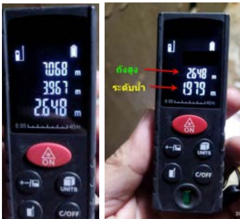
วัดขนาดมิติของถังน้ำ และระดับน้ำที่เต็ม
