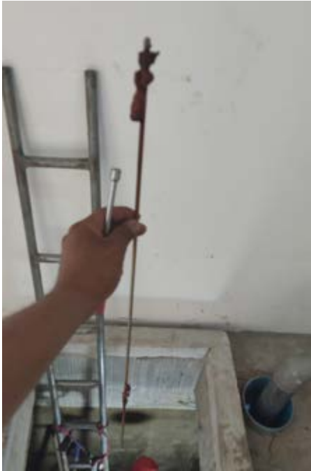
ภาพแท่งวัดระดับน้ำ เป็นสนิมหักหล่นที่พื้น
