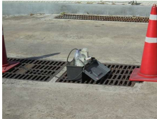
ภาพที่ 3-9 การเก็บตัวอย่างน้ำทิ้งที่บ่อตรวจคุณภาพน้ำ
