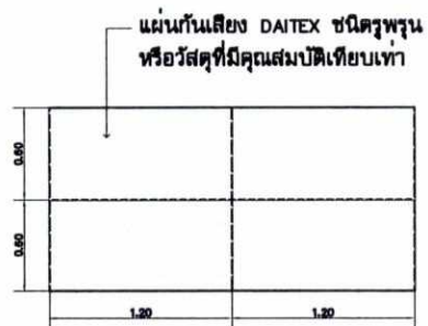
แบบขยายการติดตั้งแผ่น กันเสียง DAITEK ชนิดรูปทูน หรือวัสดุที่มีคุณสมบัติเทียบเท่า (สำหรับบริเวณชั้นที่ 2 - ชั้นที่ 10 ด่านทิศตะวันออก)
