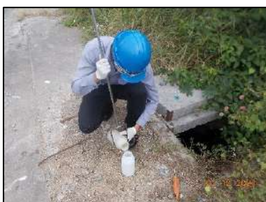
บ่อฟักน้ำทิ้งสุดท้ายก่อนปล่อยสู่แหล่งน้ำสาธารณะ
