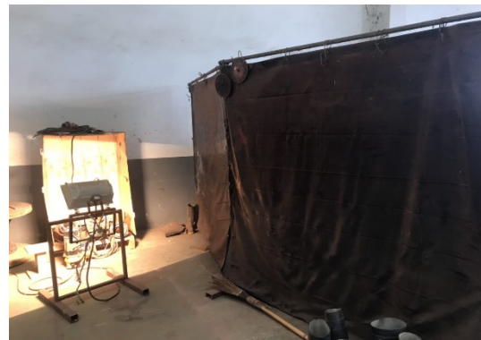
รูปที่ 2-46 จัดสถานที่ทำงานมีสภาพแวดล้อมที่ดี และปลอดภัยต่อผู้ปฏิบัติงานและผู้ร่วมงาน เช่น การ ติดตั้งแผงกันสะเก็ดไฟจากการเจียรและการเชื่อม โลหะ
