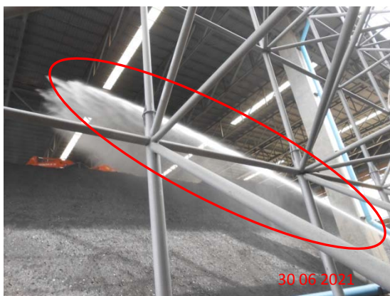
รูปที่ 4 การฉีดพรมน้ำบนกองถ่านหิน
