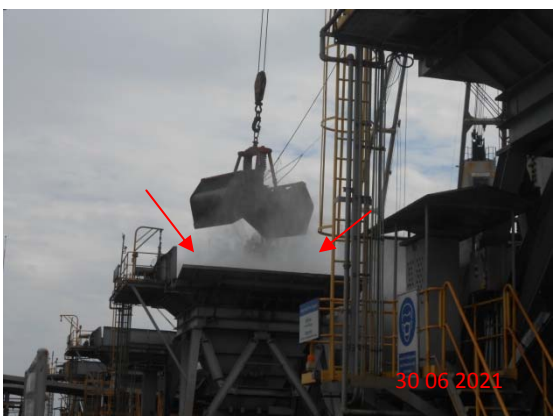
รูปที่ 3 การฉีดพรมน้ำในระหว่างขนถ่าย ถ่านหินจากเรือลงบนสอปเปอร์รับถ่านหิน
