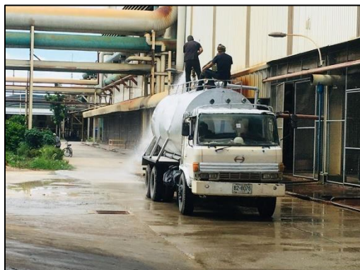
ภาพที่ 10 ฉีดพรมน้ำตลอดเส้นทางรถลำเลียงถ่าน
