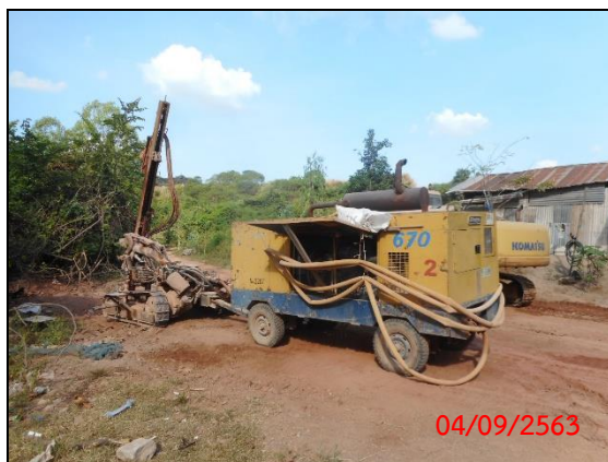
รูปที่ 2-17 เครื่องเจาะรูระเบิดที่มีอุปกรณ์เก็บฝุ่นติดไว้ กับหัวเจาะ
