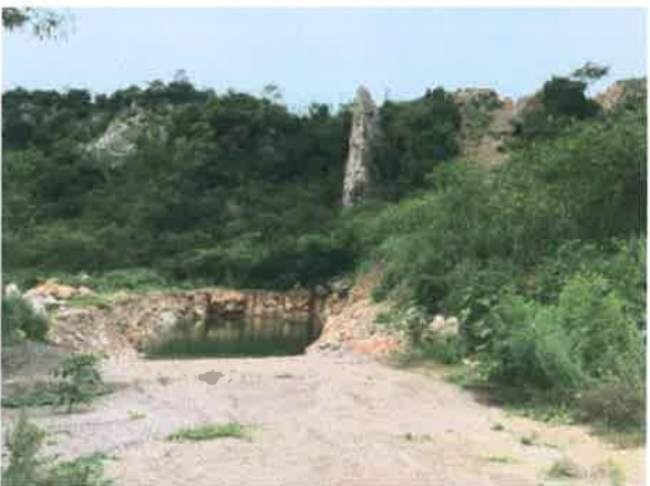
รูปที่ 5 บ่อคัดตะกอนดินรองรับการชะล้างน้ำขุ่นจันทบริเวณหน้าเหมือง
