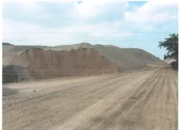
รูปที่ 4 เปลือกดินและเศษหินจากหน้าเหมืองนำมาผลิตเป็นหินคลุก
