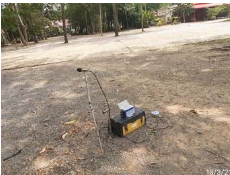
(3) ตรวจวัดแรงสั่นสะเทือนบริเวณวัดเขายายพริ้ง
