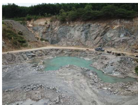
(5) บ่อรับน้ำ (sump) บริเวณพื้นที่ทำเหมือง
