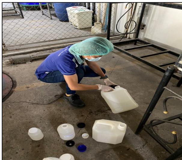
รูปที่ 3.2 การเก็บตัวอย่างคุณภาพน้ำทิ้ง บริเวณน้ำทิ้งที่ผ่านระบบบำบัดน้ำเสียบริเวณจุดรวมก่อนปล่อยลงสู่ท่อระบายน้ำสาธารณะ
