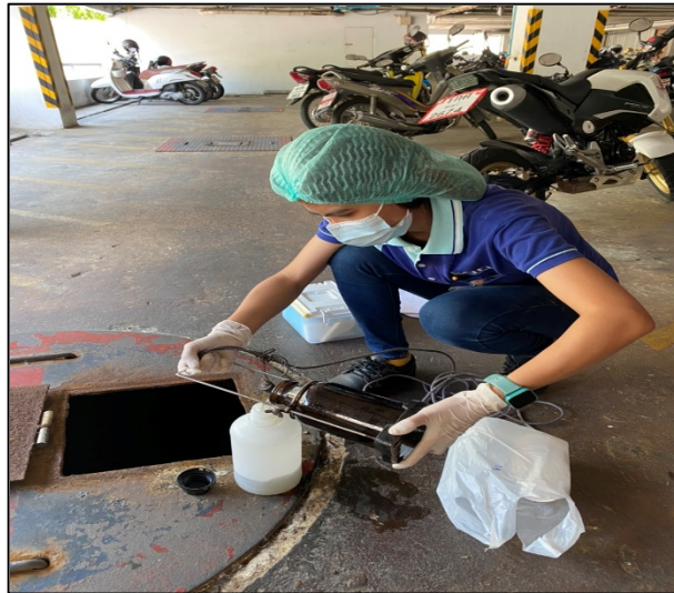
รูปที่ 3.1 การเก็บตัวอย่างคุณภาพน้ำทิ้ง บริเวณ น้ำเสียก่อนเข้าสู่ระบบบำบัดน้ำเสียของโครงการ
