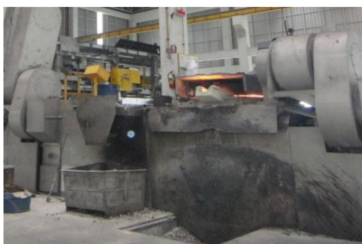
ภาพที่ 21 บ่อสำรองฉุกเฉินใต้เตาหลอม
