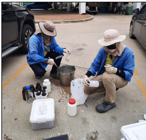
รูปที่ 3.13 การเก็บตัวอย่างคุณภาพน้ำทิ้งก่อนปล่อยออกนอกโครงการ บริเวณบ่อบำบัดน้ำทิ้ง
