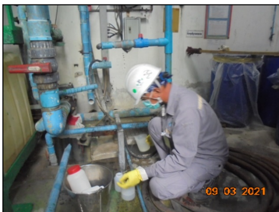
รูปที่ 3.11 การเก็บตัวอย่างคุณภาพน้ำเสียจากกระบวนการผลิต บริเวณ น้ำก่อนเข้าระบบบำบัดน้ำเสียทางเคมี
