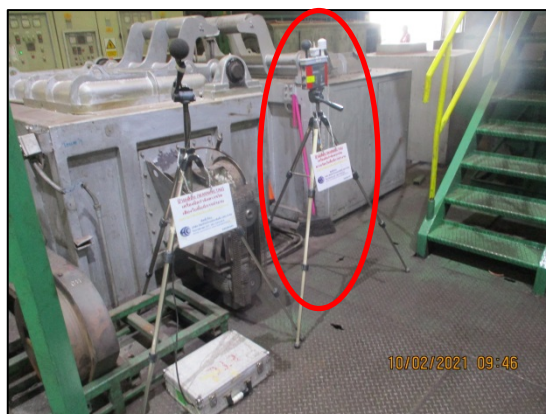
รูปที่ 3.22 การตรวจวัดระดับความร้อนในพื้นที่ทำงาน บริเวณ เครื่องอัดรีดร้อน
