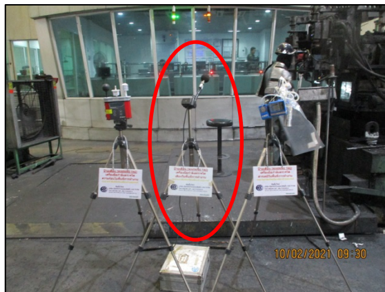
รูปที่ 3.18 การตรวจวัดระดับเสียงในพื้นที่ทำงาน บริเวณ เตาหลอม
