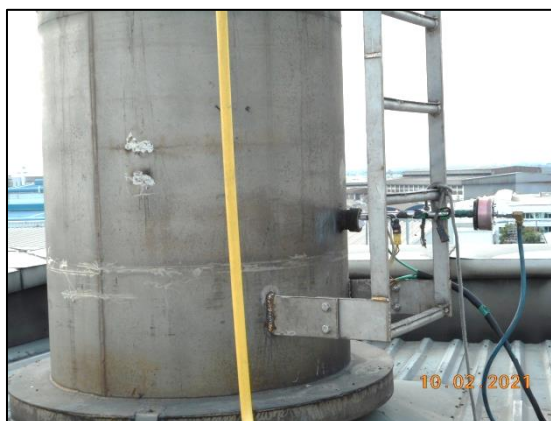
รูปที่ 3.2 การเก็บตัวอย่างคุณภาพอากาศในปล่องระบาย บริเวณ ปล่องระบายไอร้อนจากเตาหลอม
