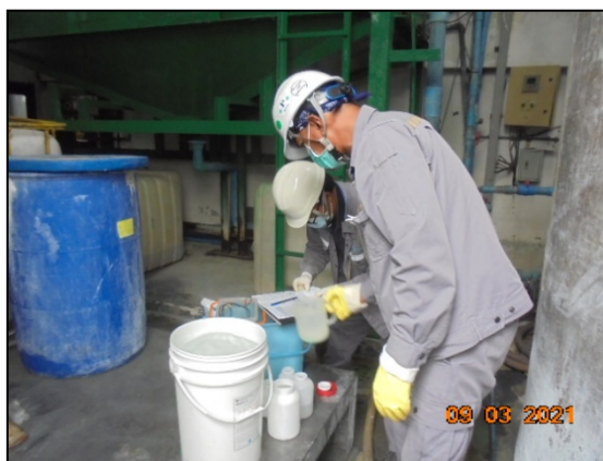
รูปที่ 3.12 การเก็บตัวอย่างคุณภาพน้ำเสียจากกระบวนการผลิต บริเวณ น้ำหลังผ่านระบบบำบัดน้ำเสียทางเคมี
