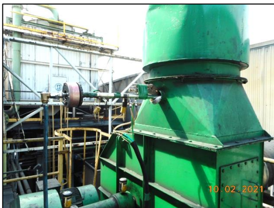
รูปที่ 3.1 การเก็บตัวอย่างคุณภาพอากาศในปล่องระบาย บริเวณ ปล่อง Wet Scrubber No.2 (เฉพาะหน่วยหลอมทองแดงเท่านั้น)
