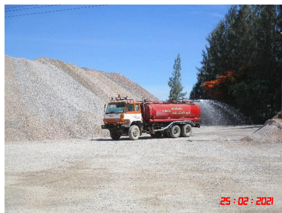
รูปที่ 2-10 การฉีดพรมน้ำบริเวณโรงโม่หินและเส้นทางลำเลียงแร่
