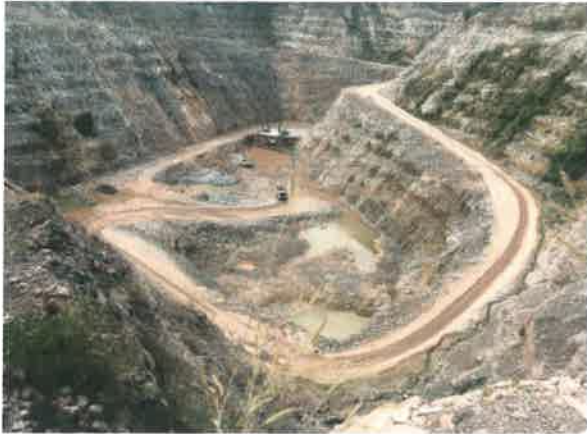
รูปที่ 1 ลักษณะหน้าเหมืองแบบขั้นบันได
