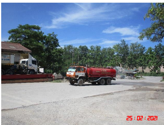
รูปที่ 2-10 การฉีดพรมน้ำบริเวณโรงโม่หินและเส้นทางลำเลียงแร่
