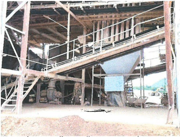
รูปที่ 19 ติดตั้งและใช้งานระบบดูดฝุ่นละออง ขณะโม่หินแบบ Bag Filter บริเวณ Secondary & Tertiary Crusher
