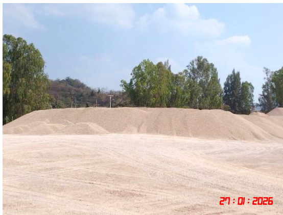
ลานเก็บกองแร่ที่เป็นลานหินบดอัดแน่น
