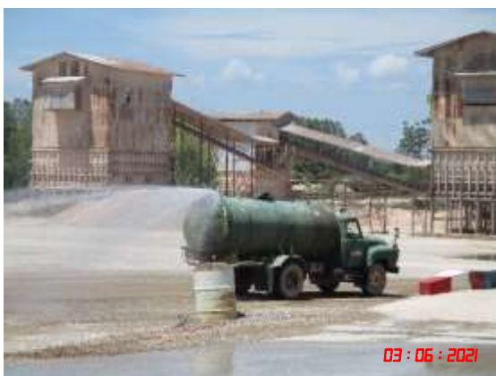
รูปที่ 2-6 การฉีดพรมน้ำบริเวณโรงโม่หิน และเส้นทางลำเลียงหิน
