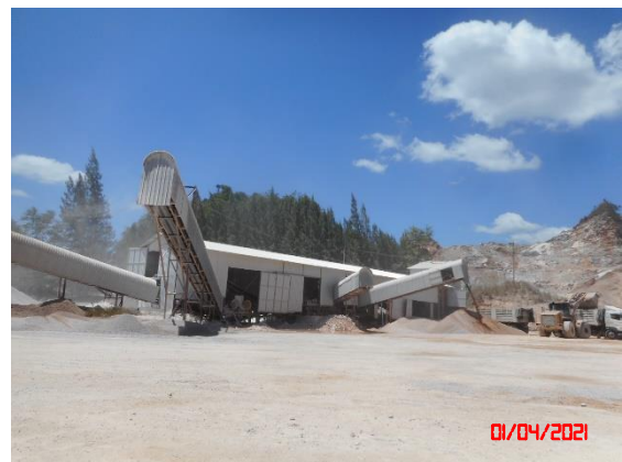
รูปที่ 2-12 อาคารปิดคลุมโรงโม่หิน 3 ด้าน
