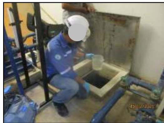
รูปที่ 43 ตรวจสอบคุณภาพถังเก็บชั้นดาดฟ้า และถังเก็บน้ำชั้นใต้ดิน
