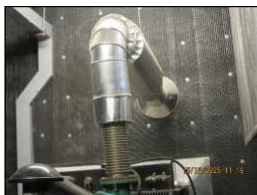
รูปที่ 16 ฉนวนกันเสียง ช่องระบายอากาศ และท่อกำจัดไอเสีย
