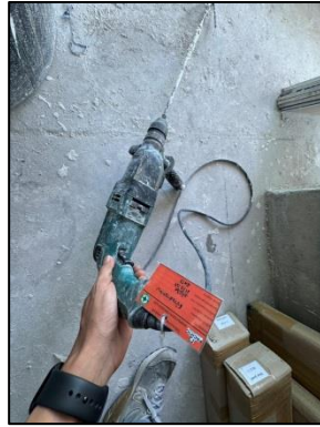
รูปที่ 17 การตรวจสอบเครื่องมือหรืออุปกรณ์ไฟฟ้าของโครงการ
