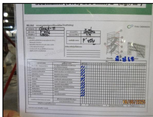
รูปที่ 88 การตรวจสอบความพร้อมของนั่งร้าน
