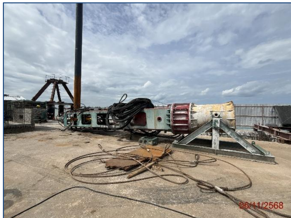
รูปที่ 2.2.1-16 Hydraulic Hammer ที่ใช้ในการก่อสร้าง ปั้นจั่น
