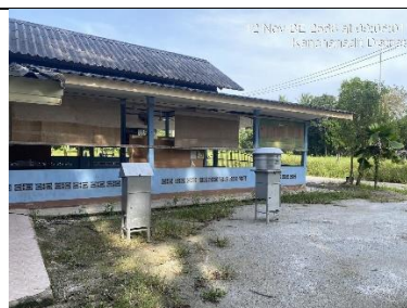
รูป 22 : ตรวจวัดปริมาณฝุ่นละอองแขวนลอยในบรรยากาศ เฉลี่ยในรอบ 24 ชั่วโมงเป็นเวลา 3 วันต่อเนื่อง ใช้เครื่อง High Volume Air Sampler จำนวน 2 สถานี
