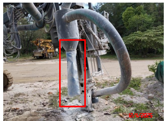
รูปที่ 21 เครื่องเจาะระเบิดที่มีอุปกรณ์เก็บฝุ่นติดไว้กับหัวเจาะ
