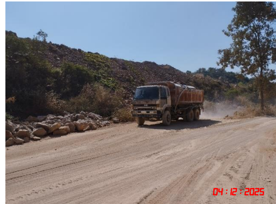
การฉีดพรมน้ำเส้นทางลำเลียงแร่บริเวณหน้าเหมืองถึงโรงโม่หิน
