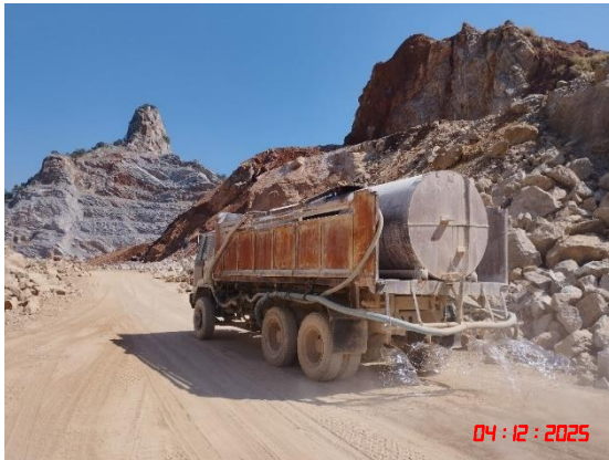
การฉีดพรมน้ำเส้นทางลำเลียงแร่บริเวณหน้าเหมืองถึงโรงโม่หิน
