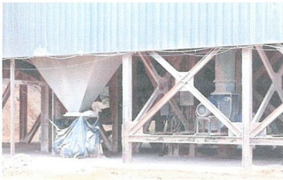
รูปที่ 20 ติดตั้งและใช้งานระบบดูดฝุ่นละออง ขณะโม่หินแบบ Bag Filter บริเวณ Secondary & Tertiary Crusher
