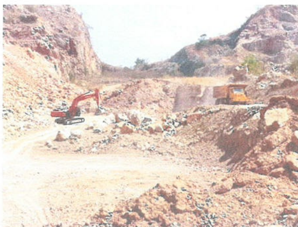
รูปที่ 2 การเปิดหน้าเหมืองเป็นชั้นบันไดจากทิศตะวันออกเฉียงเหนือสู่ทิศตะวันตกเฉียงใต้
