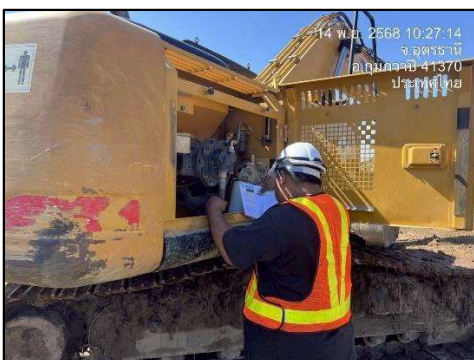
รูปที่ 2-9 การตรวจสอบเครื่องจักรและเครื่องยนต์ พร้อมทั้งติดสติ๊กเกอร์ระบุรหัสขึ้นบ่งการตรวจสอบ
