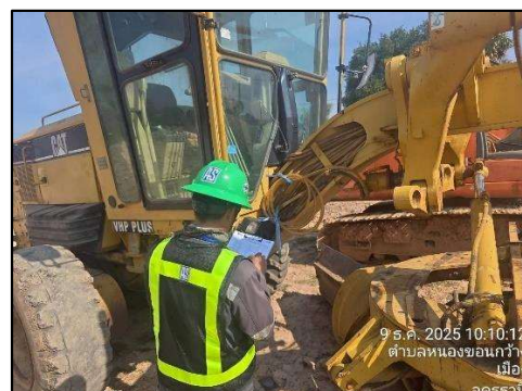
รูปที่ 2-9 การตรวจสอบเครื่องจักรและเครื่องยนต์ พร้อมทั้งติดสติ๊กเกอร์ระบุรหัสขึ้นบ่งการตรวจสอบ
