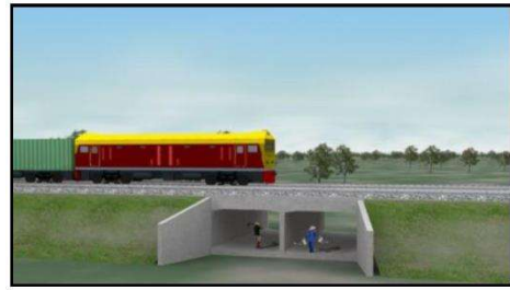
ทางลอดใต้ทางรถไฟ (Underpass Box Culvert)
