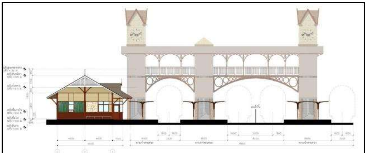
รูปที่ 1.4.1-2 รูปตัดขวางอาคารสถานีขนาดเล็ก (สถานีชั้น 2)
