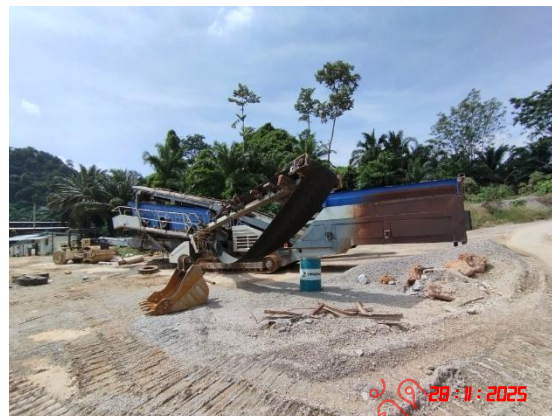
รูปที่ 25 ระบบสเปรย์น้ำบริเวณเครื่องจักรอุปกรณ์ในการบด ย่อยหินแบบเคลื่อนที่ได้
