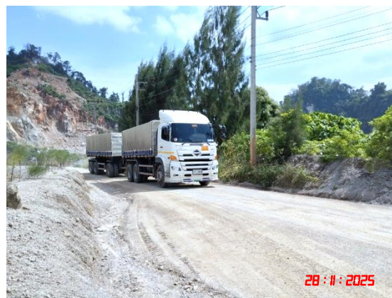
รูปที่ 19 การปิดคลุมผ้าใบรถบรรทุกแร่
