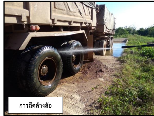
ภาพที่ 2.9 การฉีดล้างล้อรถบรรทุกขนส่งแร่
