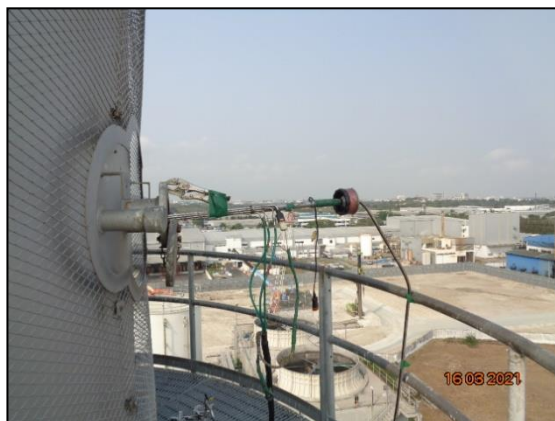
รูปที่ 3-3 การเก็บตัวอย่างคุณภาพอากาศในปล่องระบาย บริเวณ Stack HRSG23
