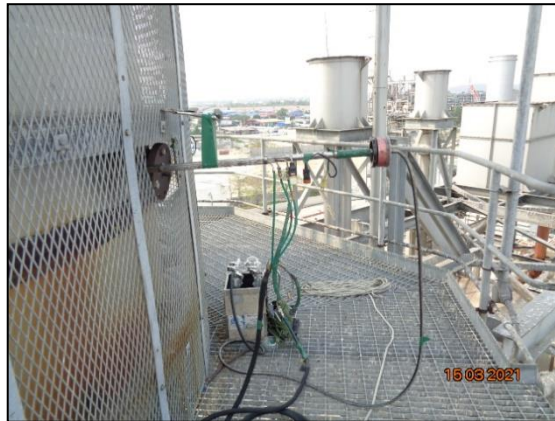
รูปที่ 3-2 การเก็บตัวอย่างคุณภาพอากาศในปล่องระบาย บริเวณ Stack HRSG22
