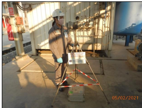
รูปที่ 3-10 การตรวจวัดระดับเสียงในพื้นที่ทำงาน บริเวณ Air Compressor
