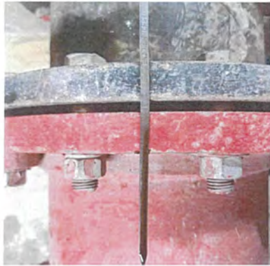
รูปที่ 1.7 ตรวจสอบน้ำมันหล่อลื่น
