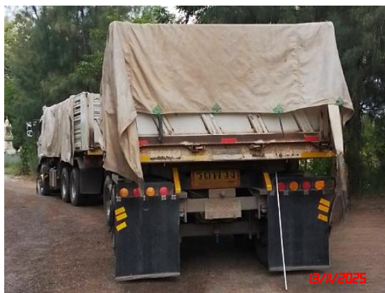
รูปที่ 17 การปิดคลุมกระบะรถบรรทุกของโครงการ
