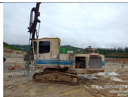
รูป 32 การเจาะรูระเบิดจะต้องติดตั้งเครื่องมืออุดฝุ่นที่ บริเวณหัวเจาะ
