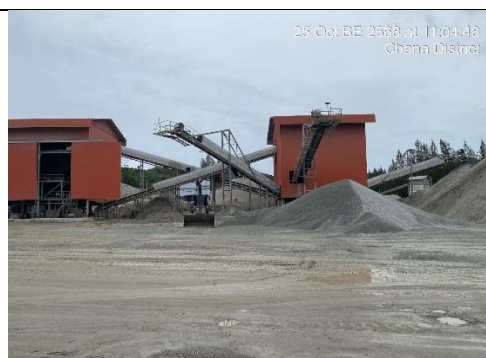
รูป 16 การปิดคลุม เครื่องบด ชุดตะแกรง สายพานและ สเปรย์น้ำ
