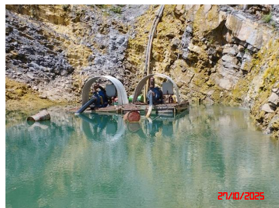
รูปที่ 15 บ่อรับน้ำ (Sump) ขุมเหมือง และเครื่องสูบน้ำ
