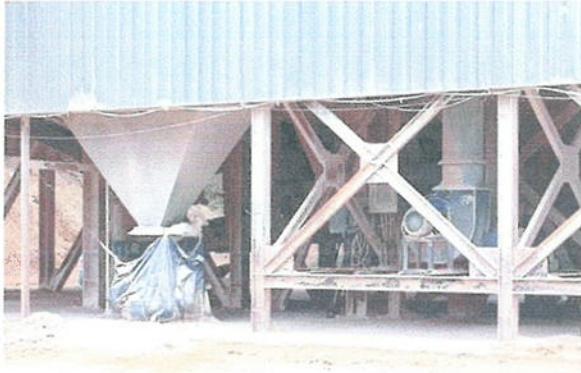
รูปที่ 19 ติดตั้งและใช้งานระบบดูดฝุ่นละออง ขณะโม่หินแบบ Bag Filter บริเวณ Secondary & Tertiary Crusher
