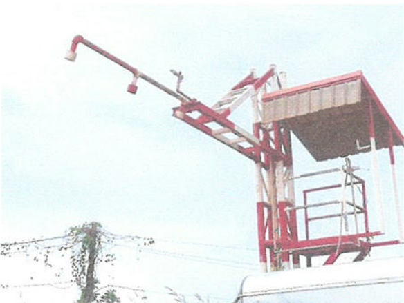
รูปที่ 21 ระบบสเปรย์น้ำบนกระบะรถบรรทุกหิน ก่อนเทหินลงปากไม้อ
