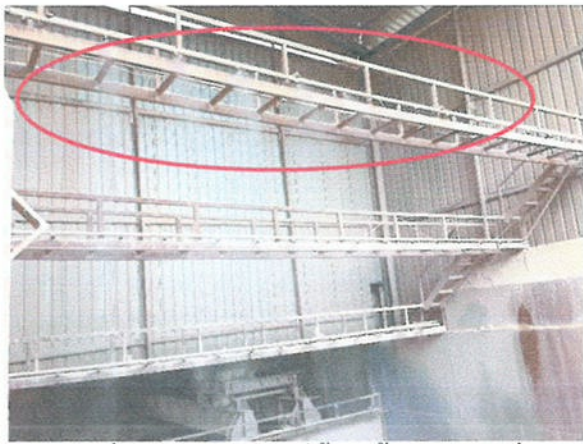
รูปที่ 19 ระบบสเปรย์น้ำในยังรับหินใหญ่ เพื่อลดฝุ่นละอองขณะเทหินเข้าปากไม้อแรก
